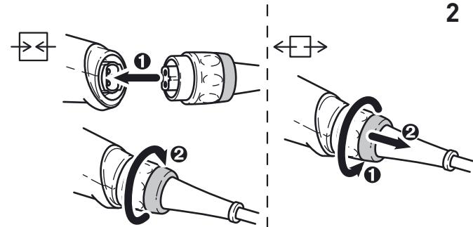
Conexión y desconexión del cable de conexión a la red -, véase la imagen 2.
