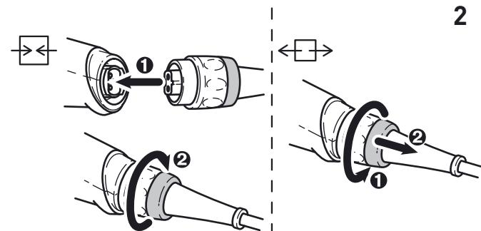
Branchemet et débranchement du câble de raccordement secteur -, voir figure 2.
