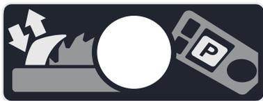
Прекарайте циркулярния диск за смяна на ножа за разклинване чрез модула за управление в паркинг позиция.
