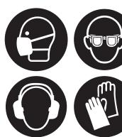
fülvédő a halláskárosodás veszélyének elkerülése érdekében; védőszemüveg; légzőmaszk az egészségkárosító anyagok belélegzésének veszélye elkerülése érdekében; védőkesztyű a szerszámok és durva anyagok kezeléséhez.
