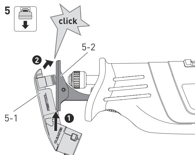
**10.6 Montage/démontage du crochet de suspension [6]**
