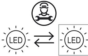
La sustitución de la fuente de luz instalada en esta herramienta debe encargarse únicamente al fabricante o a un taller de servicio técnico autorizado. De esta forma queda garantizada la seguridad de la herramienta.
