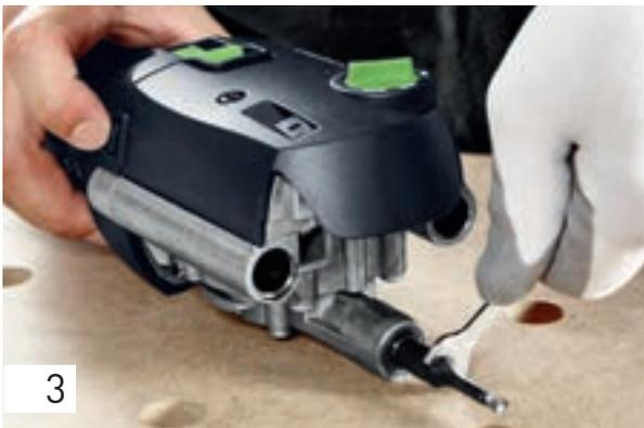
Spindelarrretierung an der Motoreinheit gedrückt halten, mit dem Gabelschlüssel den Fräser lösen und abschrauben. Den neuen, gewünschten Fräser mit dem Gabelschlüssel eindrehen, dabei die Spindelarrretierung gedrückt halten. Danach Spindelarrretierung loslassen.
