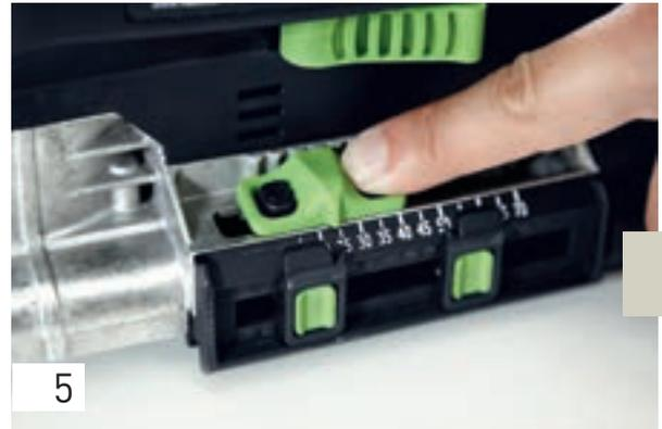
Stellen Sie für das Fräsen des Querlochs nun die Frästiefe auf 25 mm. (Dieses Maß ergibt sich individuell je nach Werkstück – siehe Maßzeichnung. Wichtig ist, dass das Querloch das Längsloch um 3 mm in der Tiefe überschneidet.)
