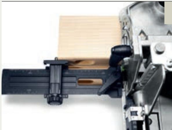
Wiederkehrende Lochabstände von 100–205 mm lassen sich einfach mit dem Queranschlag übertragen – ohne Anreißen des Werkstücks.
