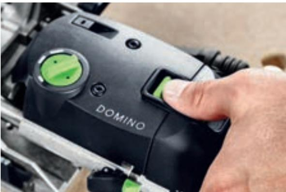
Zum Einschalten der DOMINO Dübelfräsen das plug-it Kabel mit dem Gerät verbinden, den Absaug Schlauch anbringen und dann den oben am Gerät liegenden Ein-/Ausschaltknopf nach vorne und unten schieben, bis er einrastet.
