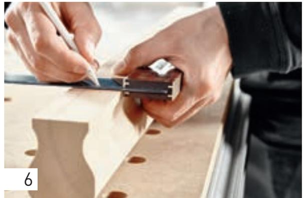
In diesen Fällen hilft ebenfalls der Leistenanschlag weiter: Zeichnen Sie die gewünschte Position der Leisten am Handlauf an, dort wo später die Fräsung sein soll. Von dieser Markierung setzen Sie eine weitere Markierung 10 mm entfernt (bei Verwendung der DF 700 sind es 15 mm) – daran legen Sie später an. Stellen Sie nun den Fräswinkel auf 90°, so können Sie senkrecht von oben in den Handlauf fräsen. Die Frästiefe beträgt beim zu verarbeitenden 6 x 40 mm Dübel wie bei den Leisten wieder 20 mm.
