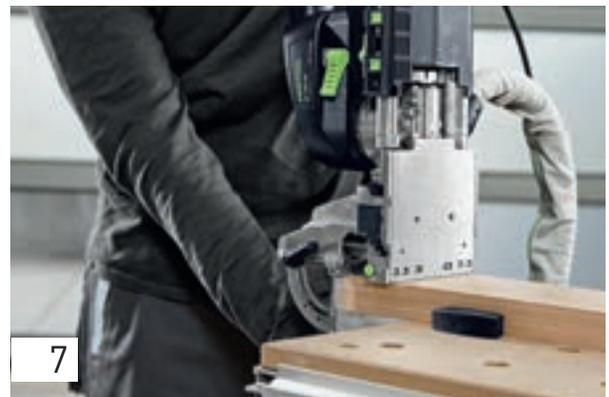
Fräsen Sie nun das Querloch dort in die Zarge, wo der Verbindereingesetzt werden soll. Dafür legen Sie die Klappe vorne an der Werkstückkante an und richten die Maschine am Anriss oder über die Anschlagpins aus (je nachdem, auf welche Weise das waagrechte Fräslloch gesetzt wurde).
