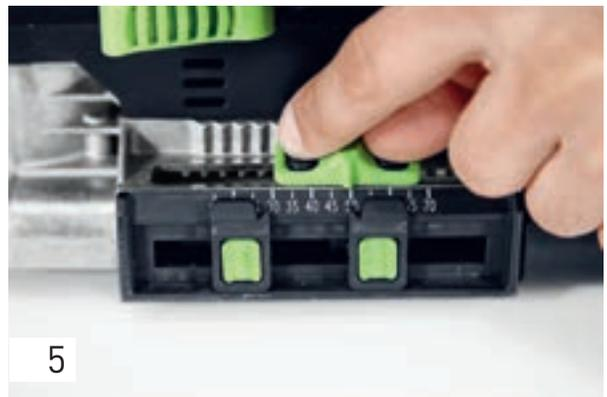
Stellen Sie nun die Frästiefe auf 50 mm ein, setzen Sie die Marker auf die 50-mm- und die 30-mm-Marke.
