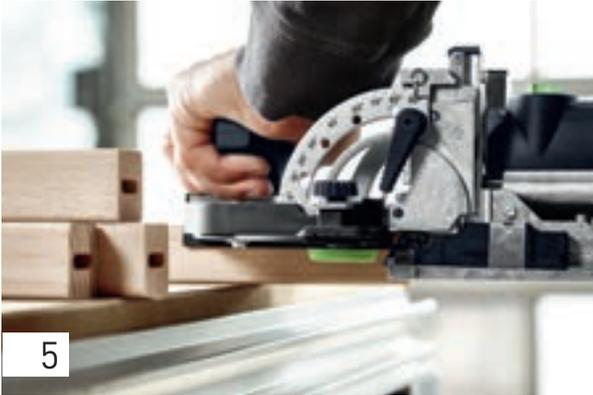
Stellen Sie die Fräshöhe auf 15 mm ein, so sitzt der Dübel später mittig in der Leiste. Die Frästiefe stellen Sie auf 20 mm ein, damit der Dübel von 40 mm Länge nachher gleichmäßig zwischen Leiste und Handlauf positioniert ist. Fräsen Sie mit der schmalen Locheinstellung das Fräsloch in die Leisten.
