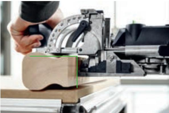
**ACHTUNG** Gerade bei Handläufen gibt es aufgrund der Formgebung des Handlaufes oftmals nicht die Möglichkeit, die Fräse sicher seitlich am Werkstück zu positionieren, weil wegen der Rundung keine sichere Auflage der DOMINO Dübelfräse möglich ist.
