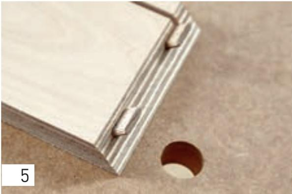
Setzen Sie die Dübel in die Fräslöcher ein, verleimen Sie diese...
