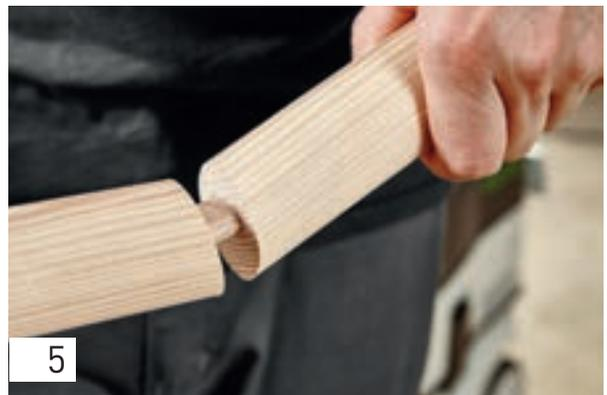
Führen Sie den 8 x 40 mm Dübel in das Fräsloch ein, unter Zugabe von Leim. Schieben Sie nun beide Werkstückteile zusammen – die Verbindung sitzt verdrehsicher mit nur einem Dübel!
