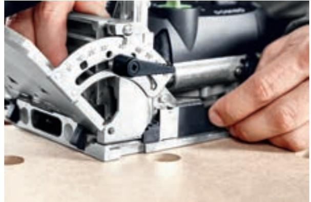
**TIPP Dünne Werkstücke auf Gehrung fräsen.** Stellen Sie den gewünschten Winkel ein. Lösen Sie den Klemmhebel für die Fräshöheneinstellung, schieben Sie den Schieber bis zum Anschlag in Richtung Motoreinheit und schieben Sie dann den Winkelanschlag komplett nach unten. Schließen Sie den Klemmhebel.
