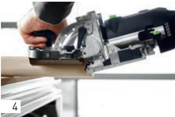
Stellen Sie den Fräswinkel an der Fräse entsprechend Ihres Sägewinkels am Werkstück ein. In unserem Beispiel wurde der Handlauf mit 15° gesägt, d. h. der Fräswinkel wird auf 75° eingestellt; errechnet aus 90° minus 15°. Fixieren Sie das Werkstück sicher, beispielsweise auf dem Multifunktions Tisch MFT. Fräsen Sie nun in beide Werkstückteile das Fräsloch ein.
