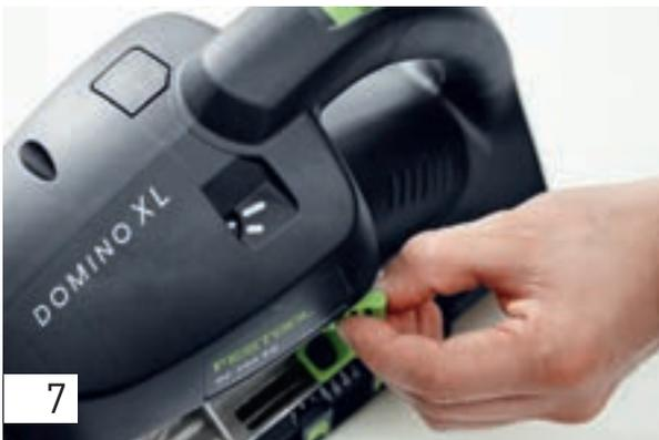
Stellen Sie für die Querslöcher die Maschine auf die große Lochbreite um; so finden die Queranker mit den darumgeclipsten Verbreiterungsclips Platz.
