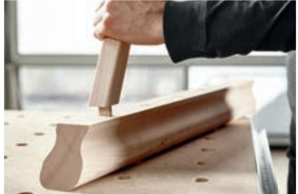
Die Fräslöcher im Handlauf setzen Sie wie oben beschrieben. Setzen Sie jetzt Leiste und Handlauf zusammen.
