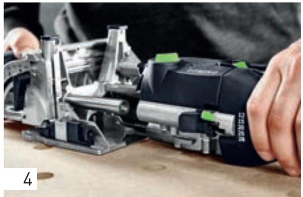
Stellen Sie vor dem Einsetzen eines neuen Fräasers sicher, dass die Maschine, das Führungsgestell und die Führungen sauber und frei von Spänen sind. Beseitigen Sie evtl. Verschmutzungen. Setzen Sie nur scharfe, unbeschädigte und saubere Fräswerkzeuge ein. Nun das Führungsgestell bis zum hörbaren Einrasten auf die Motoreinheit schieben.
