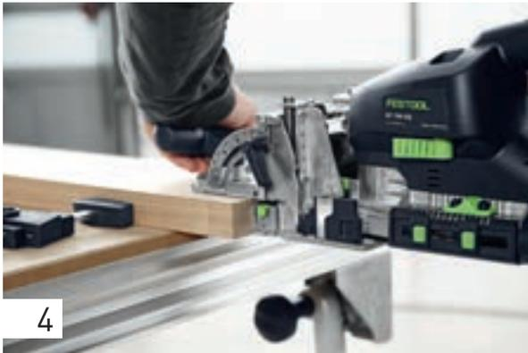
Stellen Sie die Frästiefe auf 50 mm um und fräsen Sie entsprechend des Anrisses oder über das Pin-Anschlagsystem die Fräslöcher (schmale Lochbreite) in die Zarge. Die Fräshöhe bestimmt sich individuell durch die Materialstärke; wie Sie es von der Arbeit mit Ihrer DOMINO DF 700 bereits gewohnt sind. Im vorliegenden Beispiel hat die Zarge die Materialstärke von 30 mm. Damit das Fräslloch mittig im Material sitzt, stellen Sie die Fräshöhe auf 15 mm ein.
