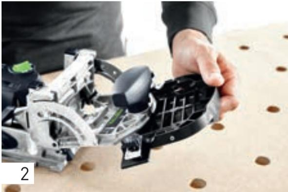
Montieren Sie den Rundprofilanschlag gemäß Bedienungsanleitung an der DOMINO DF 500 oder DF 700.
