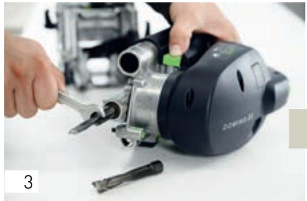
Setzen Sie den 14-mm-Fräser ein.
