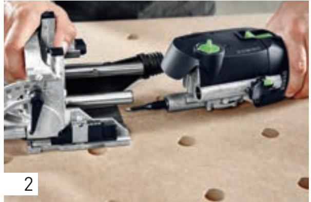
Motoreinheit und Führungsgestell voneinander lösen.
