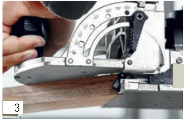
Für höchste Stabilität setzen wir pro Eckverbindung 2 Dübel. Legen Sie die Fräse an der Gehrungsschnittfläche an und fahren Sie mit der Anschlagklinke vorsichtig seitlich gegen die Spitze der Gehrung. Fräsen Sie das erste Fräsloch passgenau.
