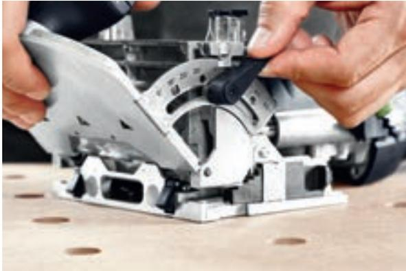
**DF 500 et DF 700** : Pour régler l'angle de fraisage, desserrez le levier de blocage de la butée angulaire. Réglez l'angle souhaité avec l'échelle graduée en continu de 0° à 90°, ou par crans sur 0°, 22,5°, 45°, 67,5°, 90°. Serrez le levier de blocage.
