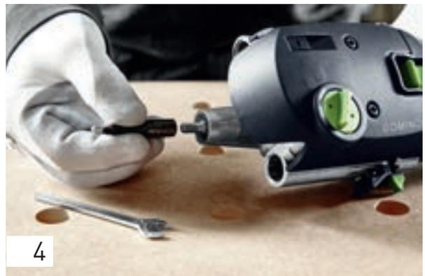
Pour utiliser un tenon de 6 x 40 mm comme dans l'exemple, utilisez une fraise de 6 mm (les tenons de 6 mm ne peuvent être utilisés qu'avec la DF 500). Reportez-vous au chapitre 1.4.4, page 18, pour remplacer la fraise.
