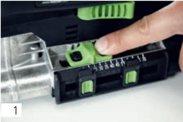
Réglez la profondeur de fraise de la fraiseuse sur 25 mm – placez pour ce faire les repères à 25 mm et 50 mm.
