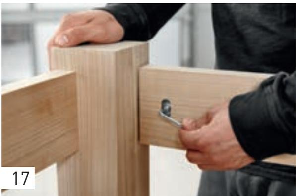
Serrez à fond le système d'assemblage amovible avec une clé Allen de 4 mm.
