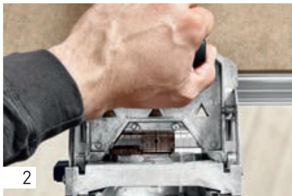
Les trous de fraisage peuvent être positionnés avec le marquage déjà repéré, le système de butée également à l'aide de l'échelle graduée dans la fenêtre d'inspection – dans notre cas, à 15 mm du bord extérieur. Pour cela, vous placez l'échelle graduée au niveau du marquage de 15 mm sur le bord de la pièce.
