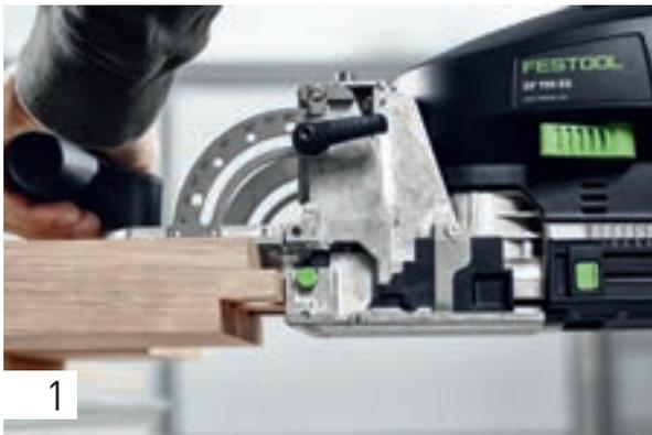
Marquez la position souhaitée du tenon et travaillez en utilisant la fenêtre d'inspection. Fraisez dans les deux pièces à travailler à la profondeur maximale (70 mm chacune) avec la fraise de 14 mm.
