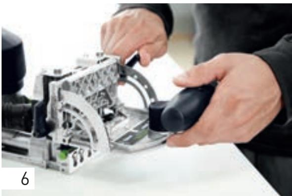
La cote de butée, à savoir le réglage de la hauteur de fraisage, doit dans chaque cas être paramétrée sur 40 mm. Ainsi le trou transversal se trouve toujours à la bonne distance du bord de la pièce et il est garanti que l'élément de fixation traversant engage alors dans l'élément transversal de verrouillage.
