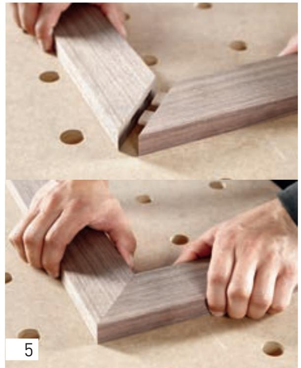
Insérez le tenon en utilisant suffisamment de colle, assemblez les frises du cadre et serrez-les à l'aide de serre-joints.
