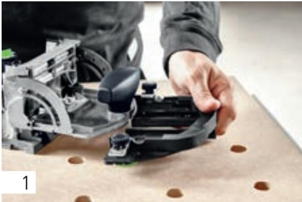
Montez la butée conformément à la notice d'utilisation sur la fraiseuse DOMINO.
