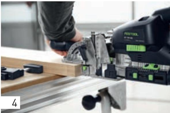
Passez la profondeur de fraisage sur 50 mm et fraisez les trous dans le châssis (largeur d'alésage étroite) en conséquence selon la ligne de découpe ou via le système de butées. La hauteur de fraisage est déterminée individuellement par l'épaisseur du matériau ; comme vous avez déjà l'habitude de travailler avec votre DOMINO DF 700. Dans cet exemple, le châssis présente une épaisseur de matériau de 30 mm. Afin que le trou de fraisage soit centré dans le matériau, réglez la hauteur sur 15 mm.
