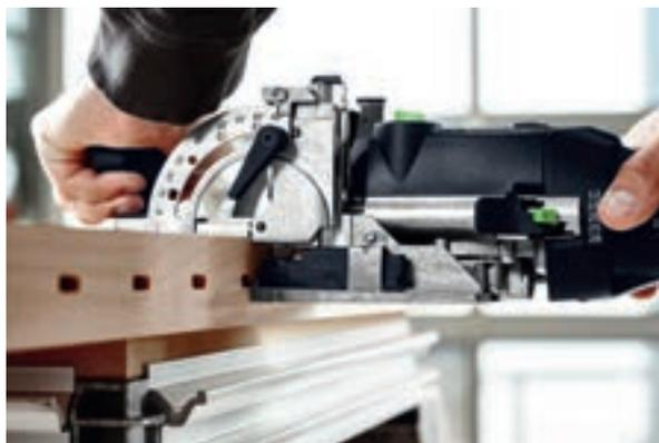
Réglez la hauteur de fraisage sur le milieu de la pièce. Dessinez sur la partie supérieure de la pièce l'entraxe des lattes. Dans ce cas (lorsque vous travaillez avec un marquage simple), placez l'échelle graduée dans la fenêtre d'inspection de la fraiseuse DOMINO en couvrant le tracé et définissez les trous de fraisage.
