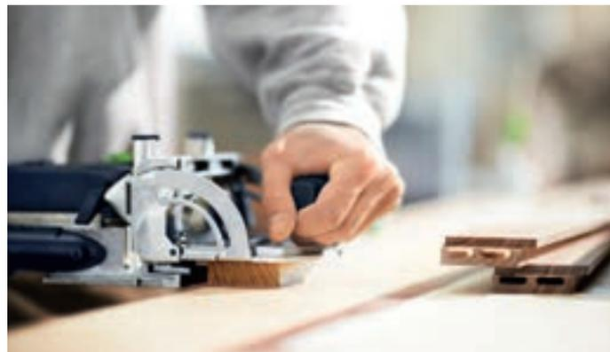
**CONSEIL** Si la frise du cadre devait ensuite être feuillurée ou rainurée, la profondeur de la feuillure doit d'abord être ajoutée lors du fraisage des trous de tenon – de sorte que le tenon reste centré par la suite en dépit de la feuillure (qui implique d'enlever une partie de la profondeur du trou du tenon).
