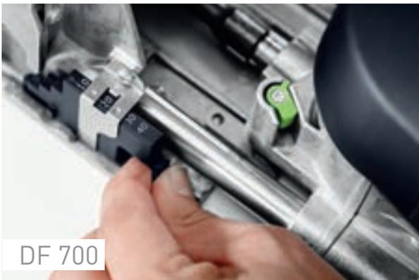
**DF 700 :** sur la DF 700, le réglage de la hauteur de fraisage se fait de la même manière que sur la DF 500. Seule différence à respecter, la hauteur du réglage de présélection n'indique pas l'épaisseur du matériau, mais la distance réelle entre la face supérieure de la pièce et le milieu du trou de fraisage.
