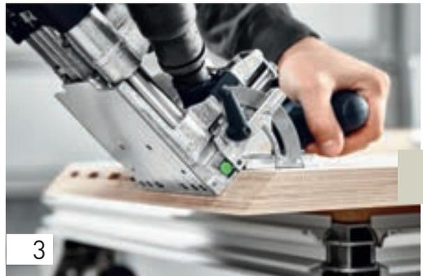
Après le fraisage du premier trou (la butée est ajustée ici au bord de la pièce), la butée plonge dans chaque trou de fraisage et fixe ainsi la butée suivante. Fraisez le premier trou avec précision et tous les autres comme trous oblongs avec du jeu.
