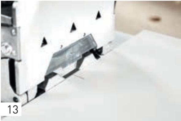
Définissez les trous supplémentaires à l'aide de l'échelle graduée dans la fenêtre d'inspection que vous alignez sur les lignes de découpe. Prévoyez tous les deux trous, un fraisage avec faible jeu – ensuite, les tenons seront encollés avant d'être positionnés avec une extrême précision.
