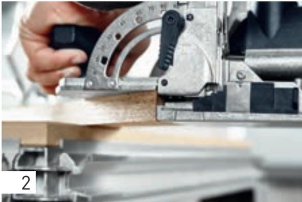
Choisissez la hauteur de fraisage en fonction de la pièce. Ici, le cadre présente une épaisseur de 20 mm. Réglez par conséquent la hauteur de fraisage de la DF 500 sur 20 mm. La largeur du cadre est, dans cet exemple, de 60 mm.
