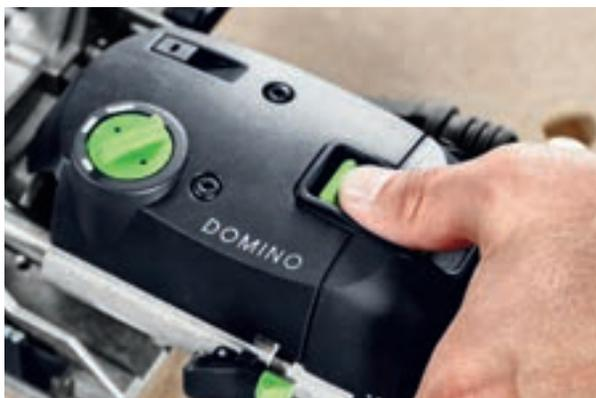
Pour mettre en marche les fraiseuses DOMINO, relier le câble plug-it à la machine, fixer le tuyau d'aspiration et pousser l'interrupteur marche/arrêt situé au-dessus de la machine vers l'avant et vers le bas jusqu'à ce qu'il s'enclenche.
