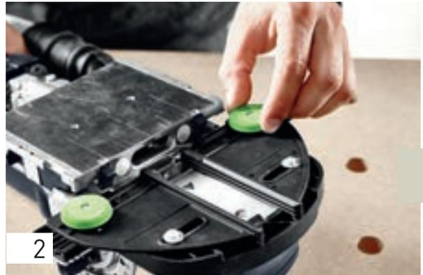
Réglez la largeur de la butée sur l'épaisseur de votre tasseau en utilisant l'échelle graduée et les molettes vertes pour paramétrer le guidage dans la butée latérale sur la dimension correspondante. Dans cet exemple, nous travaillons avec des tasseaux de 30 x 30 mm.
