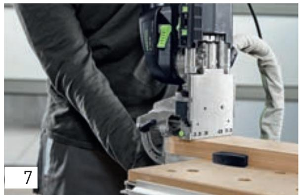
Fraisez maintenant le trou transversal dans le châssis là où le système d'assemblage doit être utilisé. Pour ce faire, appuyez le clapet à l'avant contre l'arête de la pièce et alignez la machine le long de la ligne de découpe ou via la butée (selon la façon dont le trou de fraisage horizontal a été placé).
