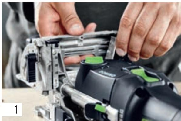
Réglez la hauteur de fraisage de façon analogue à l'épaisseur de votre pièce et sélectionnez comme profondeur de fraisage la moitié de la longueur du tenon. Vous pouvez soit fraiser les deux trous de fraisage avec la largeur d'alésage adéquate pour une précision d'ajustement extrême ; soit prévoir le deuxième trou de tenon avec du jeu.
