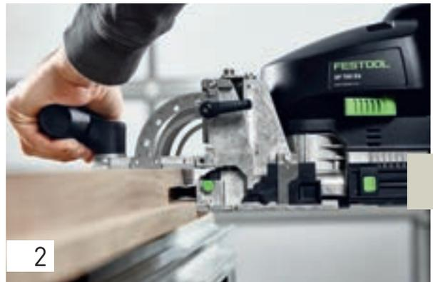
Dans la partie longitudinale, positionnez les trous de fraisage également à une profondeur de fraise de 70 mm, mais placez le premier trou de façon adéquate, puis le deuxième trou comme trou oblong avec du jeu. Procédez de la même manière pour les autres parties longitudinales et transversales.
