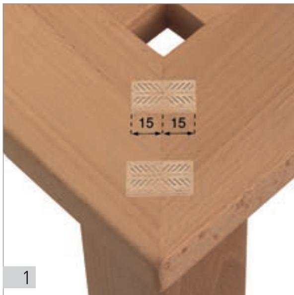
Dans cet exemple, nous travaillons avec des tenons DOMINO de 5 x 30 mm. Réglez pour ce faire la profondeur de fraise sur 15 mm.
