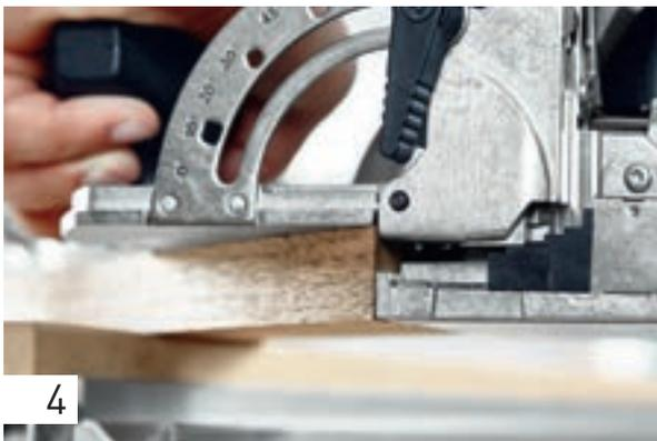
Pour le deuxième trou de fraisage, vous pouvez soit marquer d'un repère la position ou déplacer la machine à l'extérieur en affleurant au niveau de la pointe de l'onglet. Vous pouvez fraiser ce 2ème trou avec précision, comme le premier – ce qui augmente la stabilité de l'assemblage, mais qui requiert également un travail plus précis, soit vous laissez du jeu, vous devrez alors utiliser suffisamment de colle pour assurer la liaison.
