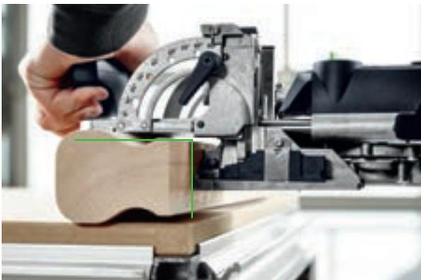
**ATTENTION** Dans le cas de mains courantes en particulier, il est souvent impossible en raison du façonnage de la main courante de positionner la fraise de façon sûre latéralement par rapport à la pièce, car l'arrondi n'offre pas de support sûr pour la fraiseuse DOMINO.
