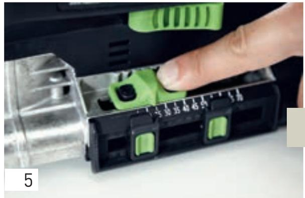
Pour fraiser le trou transversal, réglez maintenant la profondeur de fraisage sur 25 mm. (Cette cote dépend de la pièce – voir le schéma à l'échelle. Il est important que le trou transversal coupe le trou longitudinal de 3 mm dans la profondeur.)
