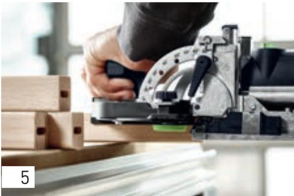
Réglez la hauteur de fraise sur 15 mm de sorte que le tenon repose ensuite au milieu du tasseau. La profondeur de fraise est réglée sur 20 mm pour que le tenon de 40 mm de long soit ensuite positionné de façon régulière entre le tasseau et la main courante. Fraisez le trou dans le tasseau avec un réglage de trou ajusté.
