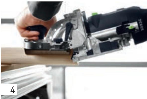
Réglez l'angle de fraisage au niveau de la fraise selon votre angle de sciage sur la pièce. Dans notre exemple, la main courante a été sciée à  $15^\circ$ , soit l'angle de fraisage réglé sur  $75^\circ$  ; calculé à partir de  $90^\circ$  moins  $15^\circ$ . Fixez la pièce de manière sûre, par exemple, sur une table multifonctions (MFT). Fraisage le trou dans les deux parties à assembler.
