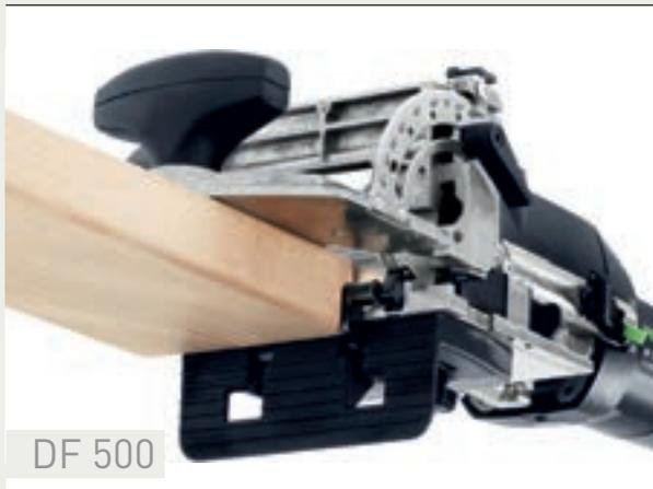
La butée additionnelle, livrée avec la fraiseuse DOMINO DF 500, augmente la surface d'appui et réduit de 37 mm à 20 mm la distance latérale des butées d'arrêt par rapport au centre du DOMINO. Cela permet un positionnement plus précis des pièces étroites.
