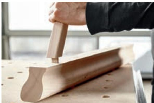
Définissez les trous de fraisage sur la main courante de la façon décrite ci-dessus. Assemblez maintenant le tasseau à la main courante.
