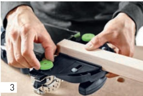
Testez avec le tasseau, si la dimension de la butée convient parfaitement et effectuez à nouveau, si besoin, quelques ajustements.
