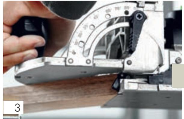
Pour une stabilité maximale, nous utilisons 2 tenons pour un assemblage angulaire. Placez la fraiseuse contre la surface de coupe à onglet et déplacez-la à l'aide du cliquet de butée avec précaution de façon latérale contre la pointe de l'onglet. Fraisez le premier trou avec précision.
