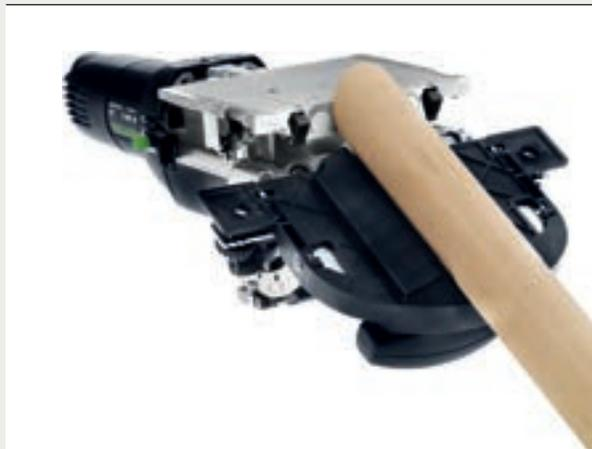
Les barres rondes de Ø 35 à 60 mm sont parfaitement fixées avec un seul DOMINO. Placer la butée ronde, ajuster, placer la pièce à travailler et fraiser.
