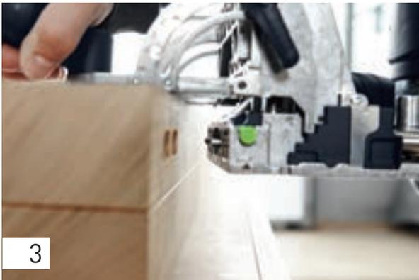
Les fraisages DOMINO dans les pieds de table / montants de lit (largeur d'alésage étroite) sont fraisés avec une profondeur de 25 mm. Réglez ainsi un fraisage pour l'ancrage d'expansion du raccord d'angle puis les autres pour la transmission des charges avec des DOMINO classiques.
