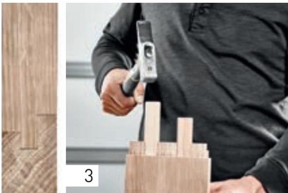
Coupez maintenant les tenons à dimension de façon correspondante aux éléments longs standardisés. Dans cet exemple, la longueur nominale du tenon est de 115 mm : cela correspond à  $2 \times$  la profondeur de fraise de 70 mm = 140 mm moins le contre-assemblage de 25 mm = 115 mm.
