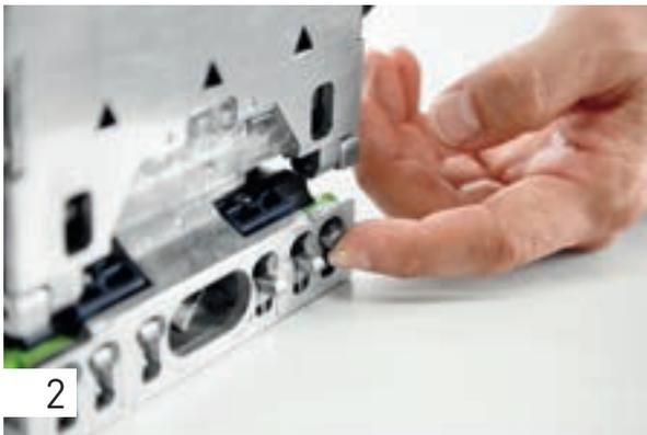
Choisissez selon la pièce, avec le système de butée, l'espacement entre les trous. Dans notre exemple, le travail est effectué avec les deux butées intermédiaires, pour un intervalle entre les trous de 37 mm.
