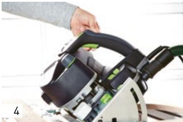
Antes de iniciar el proceso de encolado debe ajustar la velocidad deseada. Sobre todo al encolar cantos a inglete necesitará sujetar la pieza de trabajo con ambas manos.
