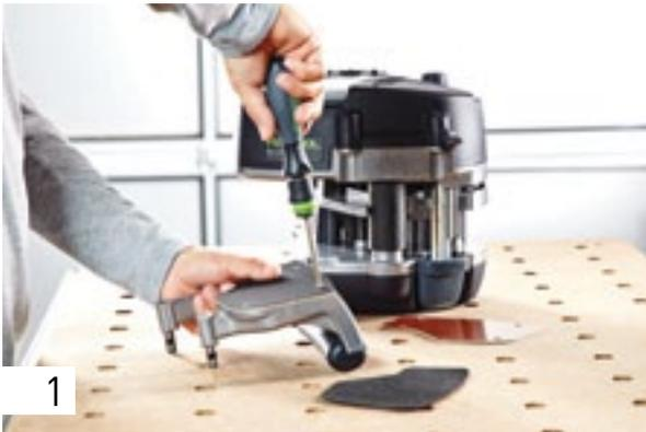
Sustituya la banda de rodadura, situada en el lado inferior de la mesa de apoyo simplemente por medio de cuatro tornillos. A continuación, fije la placa deslizante de la protección contra arañazos LAS-STF-KA 65, que se encuentra en el lado inferior con velcro.
