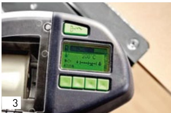
Verifique que se ha ajustado la velocidad deseada. A diferencia de la colocación móvil de los cantos, en este caso está sujeta la pieza de trabajo con ambas manos lo que dificulta modificar la velocidad durante el proceso de encolado.
