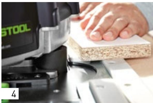
Coloque la pieza de trabajo a una distancia de 2 cm del rodillo de presión y pulse de nuevo el botón de arranque.
