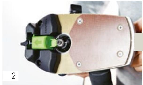
En primer lugar debe fresar el saliente del canto con la MFK 700 para que quede a ras de la tabla. Resulta práctico, porque el tubo flexible de aspiración se coloca directamente en la placa de la mesa, de modo que no obstaculiza la guía de la máquina. El freno de cojinete de bolas proporciona resultados perfectos y sin estrías.
