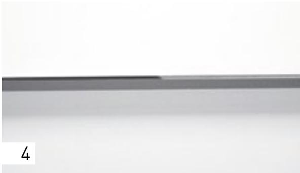
Lado derecho de la imagen: blanqueamiento del canto de plástico debido al proceso de lijado. Lado izquierdo de la imagen: canto repasado con el vellón, ya sin blanqueamiento.
