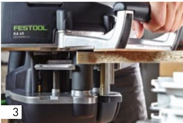
Inicie el proceso de encolado en cuanto pueda ver el canto a la derecha de la marca. Para ello deslice la máquina por el canto de la pieza de trabajo. Es la máquina la que realiza el avance. El usuario solo necesita guiar la máquina ejerciendo una presión uniforme.
