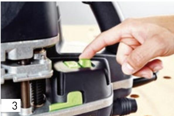
3 Con el interruptor para la preselección de temperatura, ajuste la temperatura de acuerdo con el color del cartucho de cola seleccionado.
