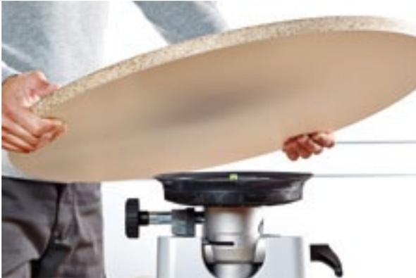
Cuando se deben colocar cantos en los cuatro lados de la tabla, resulta especialmente importante que la pieza de trabajo sea perfectamente accesible, sin necesidad de modificar la estructura. Para ello recomendamos la utilización del sistema de sujeción al vacío VAC SYS que permite la sujeción rápida y segura de las piezas de trabajo para que puedan girar 360° y bascular hasta 90°.
