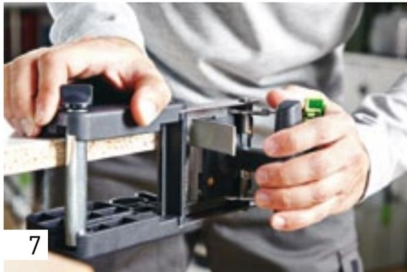
El apoyo de la mesa de dos caras de la herramienta para tronzar permite cortar igualmente bien y de forma ergonómica los cantos derechos e izquierdos de la tabla.
