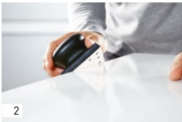
Al pulir los cantos, puede eliminar las marcas que deja la cuchilla fresadora. Para ello deslice el taco para lijar a mano por el canto con movimientos homogéneos.
