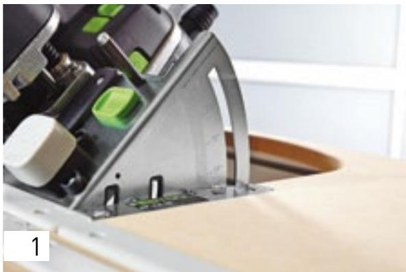
Afloje ambos tornillos de apriete en la escala de ángulos, ajuste el ángulo deseado y vuelva a apretar los tornillos de apriete.
