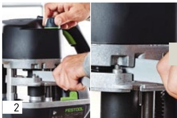
Regule la altura del canto por medio del botón giratorio, de modo que la cinta del canto esté en contacto arriba y abajo. A continuación, gire el interruptor 1-2 puntos de encaje hacia atrás para que la cinta del canto disponga de un poco de juego.
