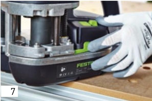
7 Luego, presione la palanca de seguridad para el enjuague y, al mismo tiempo, gire el botón giratorio en el sentido contrario a las agujas del reloj hasta que la placa media se sitúe en la parte inferior de la herramienta. Se ha alcanzado la posición de enjuague.
