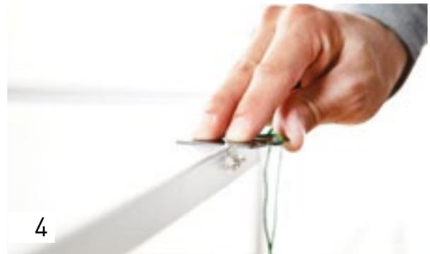
Deslice la fresadora de cantos (con la fresadora en marcha) sobre el canto para fresar el saliente y el radio a fin de obtener un canto limpio y romo.
