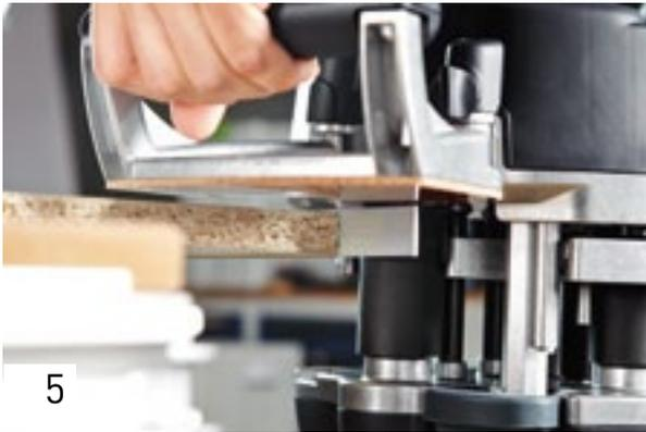
Una vez se haya canteado la pieza de trabajo, retire la máquina en el sentido del canto.
