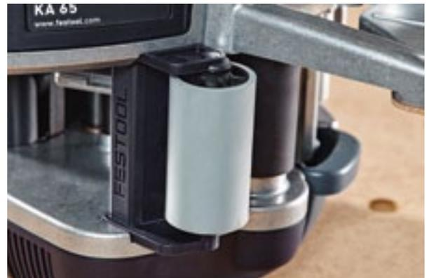
El rodillo adicional (accesorio) es útil para los radios estrechos o puntos de difícil acceso. Aumenta el radio de flexión del canto y proporciona durante la colocación un punto de presión adicional para mejorar el proceso de encolado. Para el montaje del rodillo adicional, desplácelo por la ranura prevista hasta que quede encajado.
