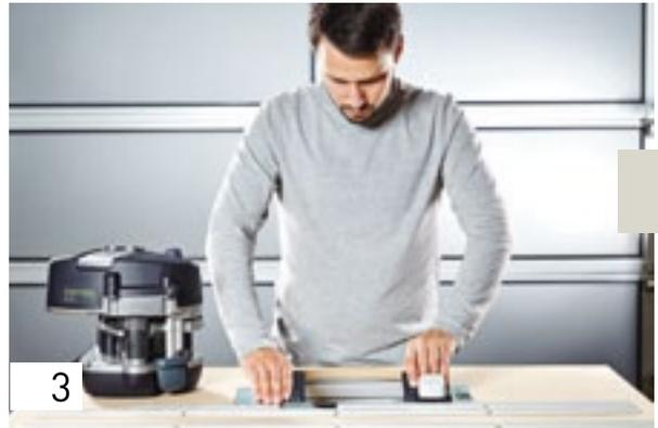
Para colocar la CONTURO en la placa adaptadora: en primer lugar, incline la placa adaptadora hacia arriba para bloquearla.
