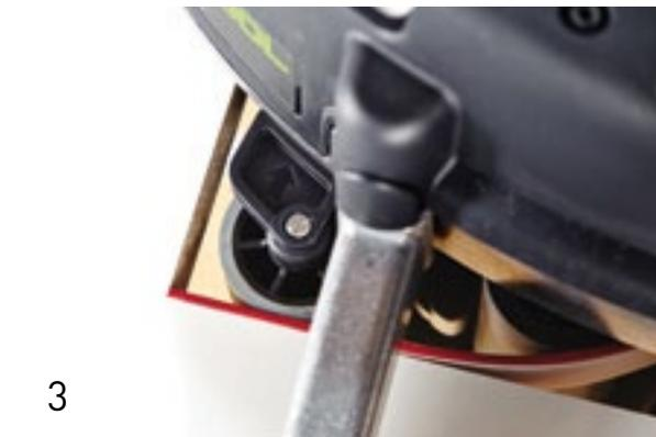
En cuanto el extremo de inicio del canto alcance la escuadra interior, deslice la máquina fuera de la escuadra interior por medio de una presión homogénea. Simultáneamente presione con el pulgar de la mano derecha sobre el extremo del canto en la escuadra interior para conseguir un encolado óptimo.
