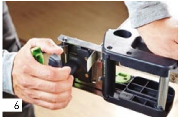
Con la herramienta para tronzar KP 65/2 de Festool puede cortar el saliente del canto: Introducir la cinta del canto entre las cuchillas. Colocar la herramienta para tronzar en los bulones tope y en paralelo con la pieza de trabajo. Presionar las empuñaduras.
