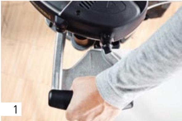
Coloque la CONTURO con el canto recogido con la mesa de apoyo sobre la pieza de trabajo. Mantenga una distancia de aprox. 2 cm entre la pieza de trabajo y el rodillo de presión. Es importante que la máquina tenga una alineación en un ángulo de 90° con respecto al canto de la tabla. El indicador se encuentra al inicio de la tabla.
