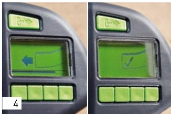
Cuando aparezca el símbolo para el alojamiento para cantos, introduzca el canto (con el avance en funcionamiento) hasta que quede recogido. Cuando el canto alcanza la posición de arranque y la máquina está lista para encolar, aparece la marca de confirmación en la pantalla.
