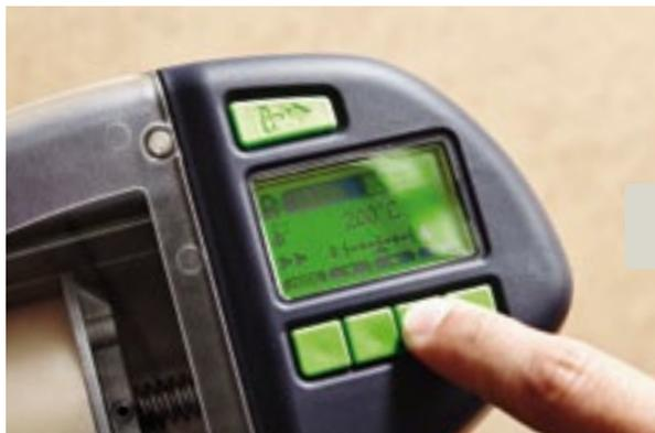
**CONSEJO** También puede ajustar la temperatura individualmente: presionar el botón de modo hasta que el indicador de temperatura parpadee, ajustar la temperatura deseada con los botones de flecha y confirmar con OK.
