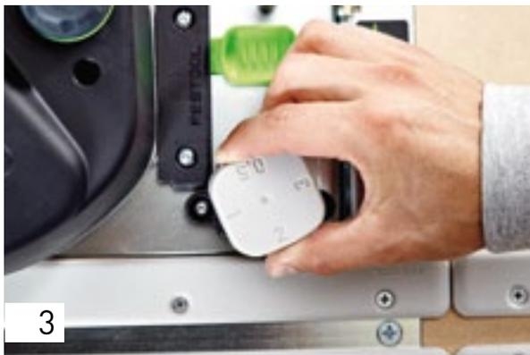
A fin de evitar que el canto se desplace y se encole torcido, utilice simplemente el tope de guía. Así garantizará un guiado en paralelo a la pieza de trabajo. Ajuste el tope de guía al grosor del canto utilizado. Los grosores disponibles son: 0,5; 1; 2 y 3 mm.
