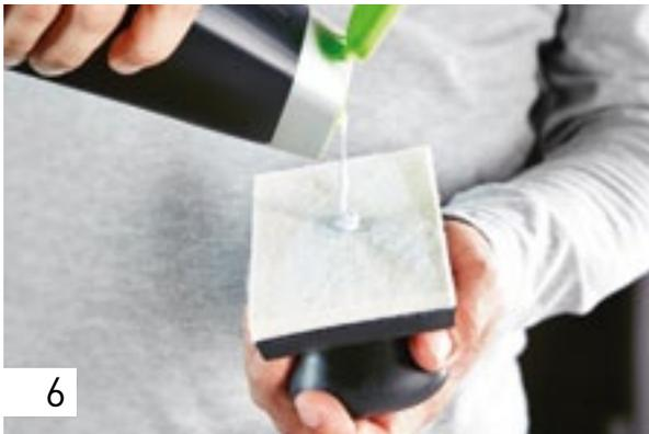
Aplique un poco de abrillantador MPA 6000 sobre el fieltro de pulido y extiéndalo frotando sobre la superficie.
