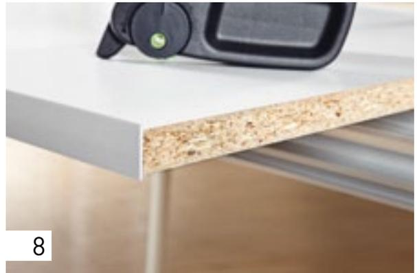
El resultado: un canto cortado preciso y a ras. Por otra parte: La herramienta para tronzar KP 65/2 es adecuada para cantos con una altura de 18–65 mm, así como para un grosor de canto de 0,5–2,0 mm. La distribución de las empuñaduras para tronzar en dirección del tronzado facilita mucho el trabajo, incluso para cantos más gruesos.
