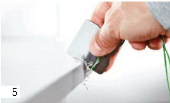
Si todavía se perciben los rastros del proceso de fresado (cuchilla), puede utilizar el rascador para pulir.
