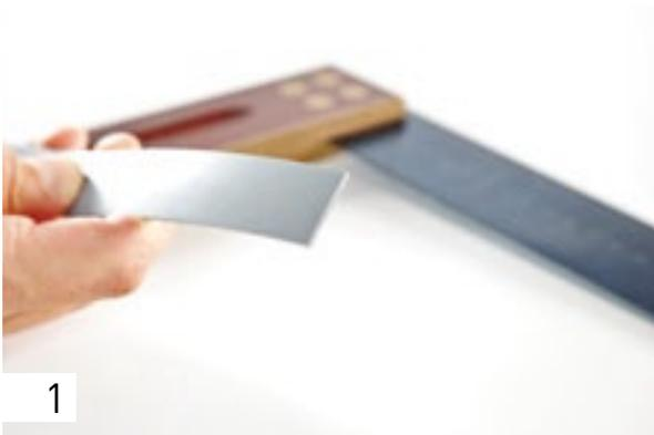
Al cortar el canto debe añadir 10 cm más de lo necesario. Corte el extremo con el que va a empezar en ángulo recto de forma exacta, puesto que este corte representa automáticamente una parte de una unión.
