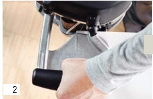
Pulse de nuevo la tecla de arranque. El canto se humedece automáticamente con cola y se adosa a la pieza de trabajo. Ahora la máquina funciona automáticamente, ya no se requiere mantener pulsada la tecla de arranque.
