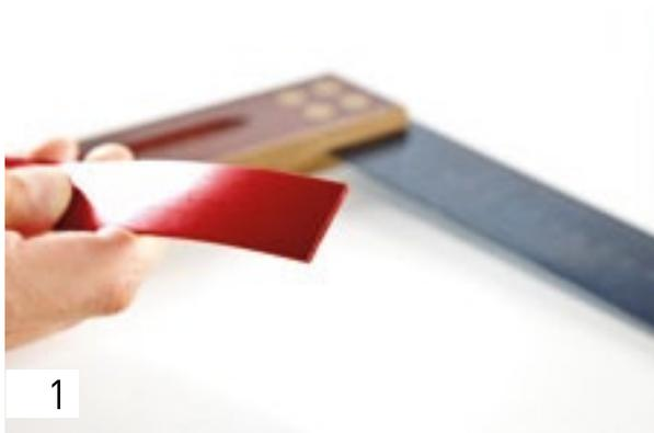
Corte el extremo del canto con el que va a empezar en ángulo recto exacto, puesto que este corte representa automáticamente una parte de la unión.
