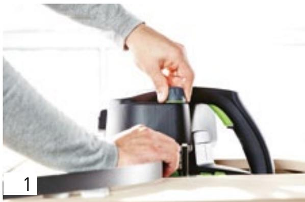
Ajuste la altura del canto con algo de juego para que este pueda deslizarse con facilidad por la máquina.
