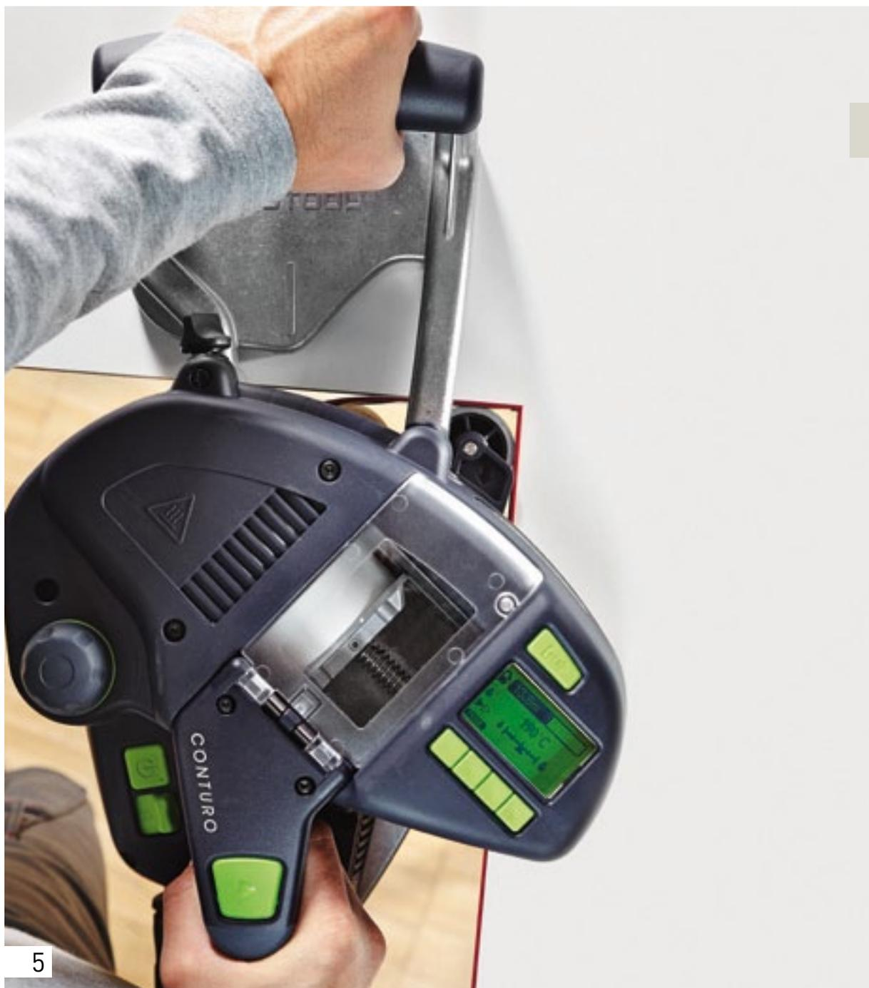
5 Gire la tabla de tal forma que la escuadra interior se sitúe de nuevo en el lado derecho de la máquina. De ese modo podrá deslizar la máquina otra vez de derecha a izquierda por el lado al que todavía se le ha de colocar el canto.
