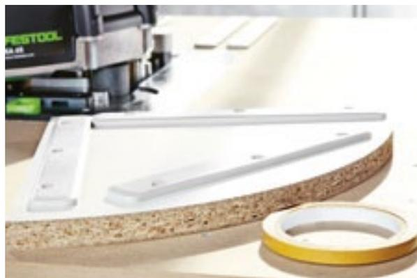
**CONSEJO** Si se requiere desatornillar todas las placas deslizantes, lo mejor es sujetarlas con una cinta adhesiva de dos caras a la parte inferior de la pieza moldeada. De ese modo, está de nuevo a la altura correcta con respecto al cubrecantos o a la cinta del canto y conseguirá el saliente de canto correcto.
