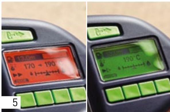
La herramienta se calienta hasta alcanzar la temperatura nominal. Le sigue la fase de calentamiento, durante la cual la pantalla parpadea. En el momento en que la pantalla cambia de rojo a verde, la herramienta está lista para su funcionamiento.
