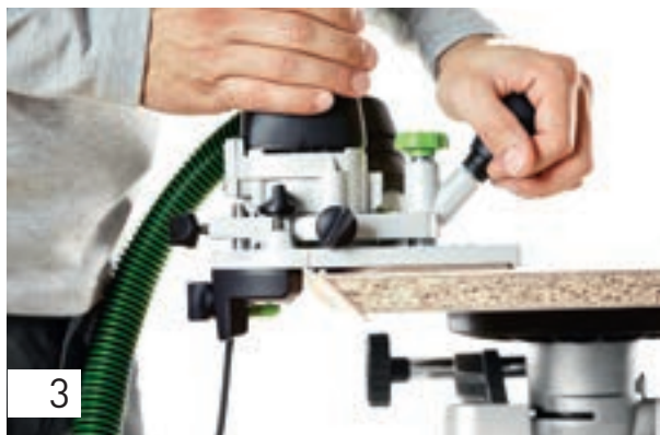
3 Veillez à ce que le capot d'aspiration se trouve contre la pièce et puisse être utilisé comme guide.
