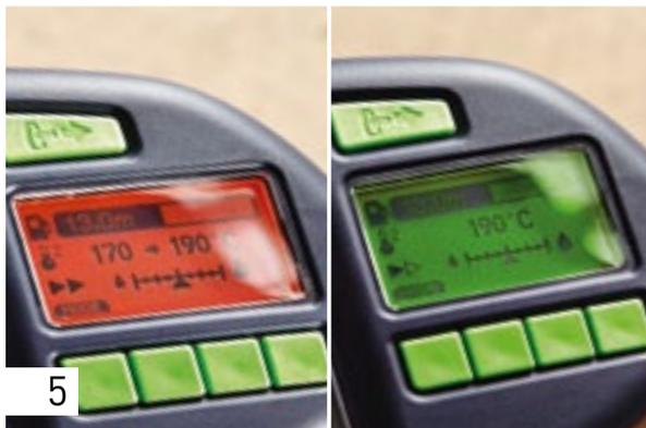
L'utensile si riscalda fino a raggiungere la temperatura impostata. Durante la fase di riscaldamento il display lampeggia. Non appena il display passa da rosso a verde significa che l'utensile è pronto per essere utilizzato.
