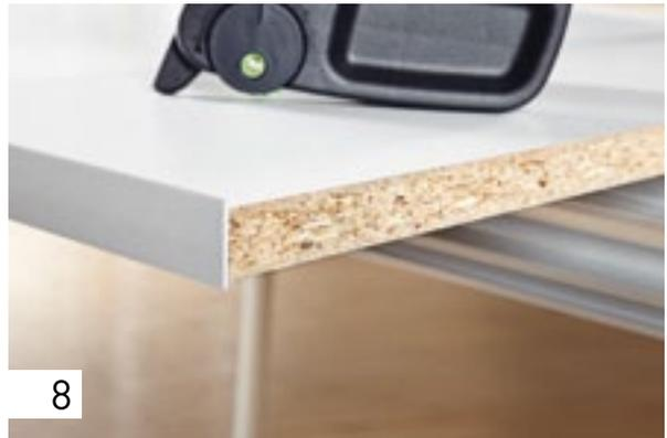
Il risultato: un bordo perfettamente a filo e troncato. Inoltre: la troncatrice KP 65/2 è adatta a bordi con altezza di 18-65 mm e spessore di 0,5-2,0 mm. Disponendo le impugnature in direzione del taglio, la troncatura anche di bordi più spessi è molto più semplice.
