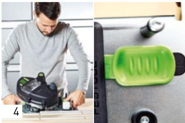
Allentare il bloccaggio a destra e a sinistra sul pannello, inserire CONTURO e bloccarlo nuovamente.
