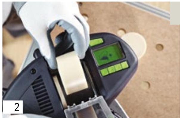
Ora, imposta manualmente la temperatura di esercizio su 140 °C (per la regolazione manuale della temperatura, vedere pag. 23). Inserisci poi un'altra cartuccia di colla poliuretanic e premere fino a circa metà della macchina fino a quando non si vede più nessuna miscela. Attendi che la bordatrice si raffreddi a 140 °C - e la macchina a questo punto è pronta all'uso.
