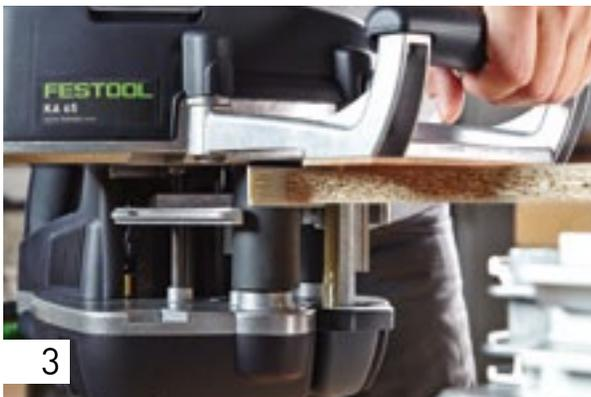
Non appena il bordo diventa visibile a destra della linea di riferimento, iniziare ad applicare la colla guidando la macchina lungo il bordo del pezzo. L'avanzamento viene eseguito dall'utente, l'utente deve soltanto tenere CONTURO esercitando una forza omogenea.
