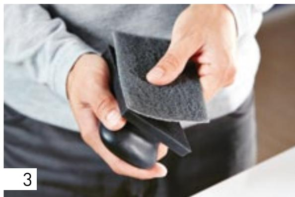
Levigando il bordo in plastica spesso si modifica l'estetica, il bordo diventa bianco. Per adattare nuovamente il colore al mobilio, applicare sul tampone di levigatura manuale l'abrasivo vlies ed eseguire la lavorazione. Con il suddetto abrasivo si ottiene un effetto seta sui bordi in plastica, la superficie del bordo diventa omogenea con la maggior parte delle superfici.
