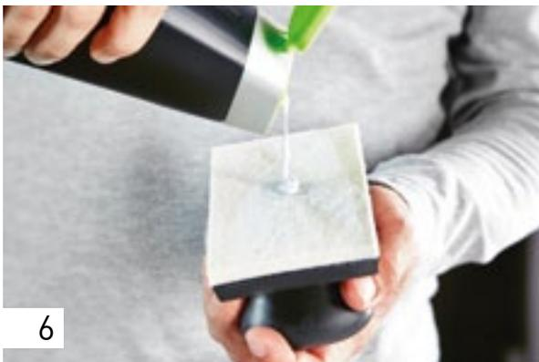
Applicare un po' di pasta di lucidatura MPA 6000 sul feltro e strofinare la superficie.
