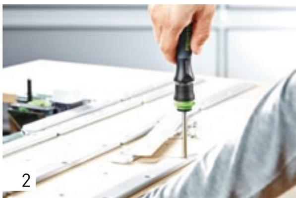
Successivamente, montare la piastra adattatrice e le solette di scorrimento come indicato sulle istruzioni per l'uso. Le solette di scorrimento semplificano la guida del pezzo sopra il banco. Con la piastra adattatrice vengono fornite in dotazione anche 15 solette di ricambio (altre sono disponibili come accessori).
