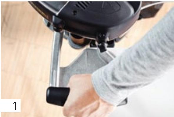
Posizionare CONTURO con il piano di appoggio sul pezzo e con il bordo in posizione ritratta. Tenere tra il pezzo e il rullo di compressione ca. 2 cm di distanza. È importante allineare la macchina a 90° rispetto al bordo del piano. La linea di riferimento si trova all'inizio del piano.
