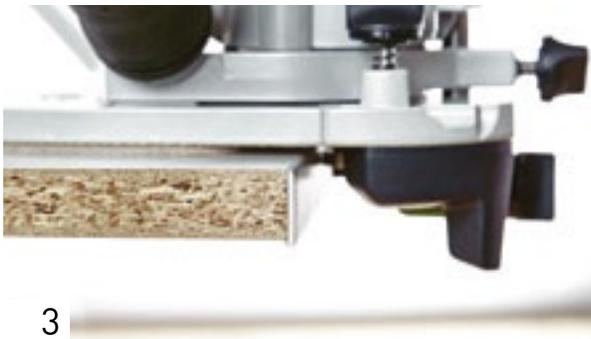
Per ottenere un bordo pulito e smussato, appoggiare il rifilatore sul bordo con la fresa già in funzione e guidarlo lungo il perimetro per fresare via la sporgenza e il raggio.
