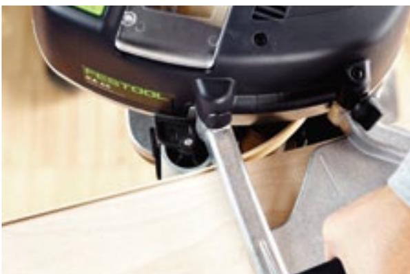
Anche per l'applicazione di bordi rigidi e fragili è vantaggioso lavorare con il rullo supplementare. Grazie a questo ulteriore appoggio, il bordo ha un raggio di piegatura più ampio e non si rompe facilmente.
