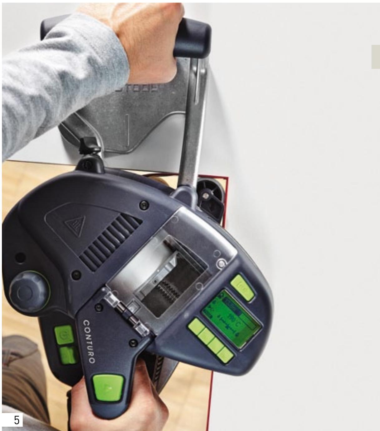
Ruotare la piastra in modo tale che l'angolo interno si trovi nuovamente sul lato destro della macchina. In questo modo è possibile guidare nuovamente la macchina da destra a sinistra sull'angolo già bordato.
