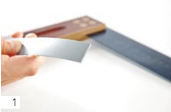
Prima di tagliare il nastro per il bordo aggiungere circa 10 cm alla misura necessaria. Tagliare l'inizio del nastro in senso perfettamente perpendicolare, in quanto questa parte corrisponderà a una metà del giunto.
