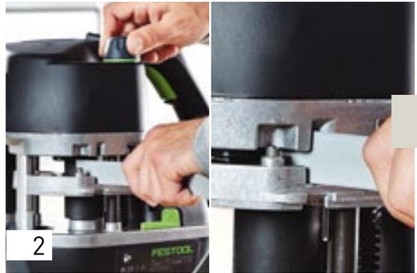
Regola l'altezza del bordo con la manopola girevole in modo tale che il nastro si appoggi sia in alto che in basso. Infine, ruota l'interruttore indietro di 1-2 scatti, in modo che il nastro abbia un po' di gioco.
