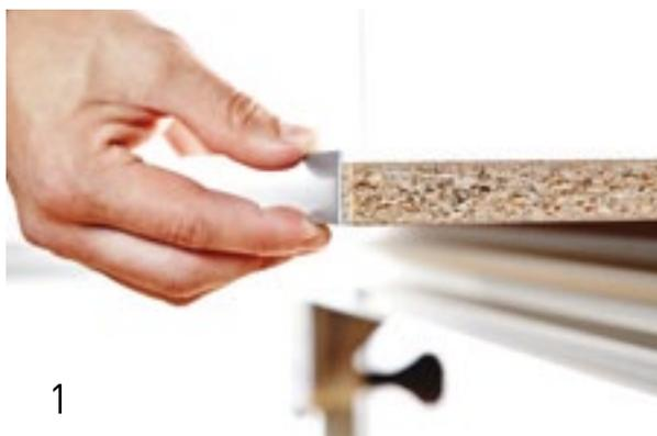
Scegli l'altezza del bordo sulla base dello spessore del materiale aggiungendo ca. 4 mm.
