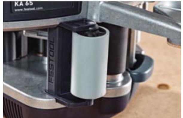
Per raggi stretti e punti difficili da raggiungere, il rullo supplementare (accessorio) risulta utile. Aumenta il raggio di curvatura del bordo, offrendo durante l'avanzamento un punto di compressione aggiuntivo per un incollaggio migliore. Per il montaggio del rullo supplementare, spostarlo nella scanalatura apposita fino allo scatto.
