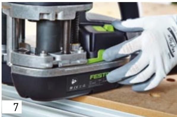
Ora premere la leva di sicurezza per il lavaggio ruotando nel contempo la manopola in senso antiorario fino a quando la piastra centrale si trova in basso sull'utensile. A questo punto è raggiunta la posizione di lavaggio.
