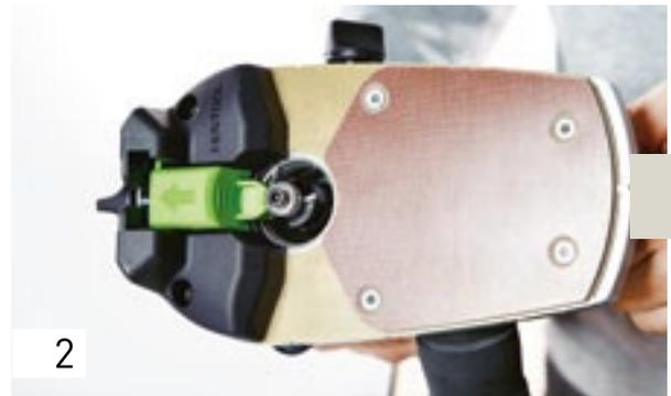
Fresare dapprima la sporgenza del bordo con MFK 700 a filo rispetto al pannello. Pratico: il tubo flessibile di aspirazione viene applicato direttamente sul piano del banco, in modo che non ostacoli la guida della macchina. Il freno cuscinetto a sfera consente di ottenere risultati perfetti, privi di striature.
