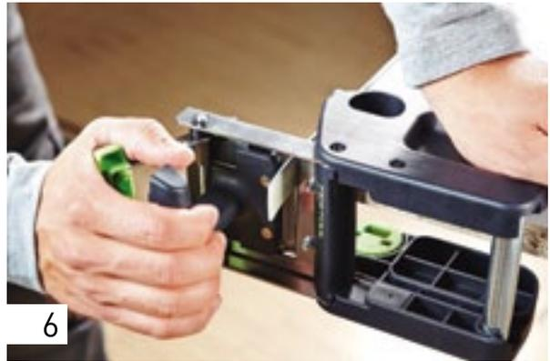
La troncatura del bordo sporgente si esegue con la troncatrice Festool KP 65/2: introdurre il nastro per bordi tra le lame, posizionare la troncatrice fino al perno di riscontro parallelamente al pezzo e premere insieme le impugnature.
