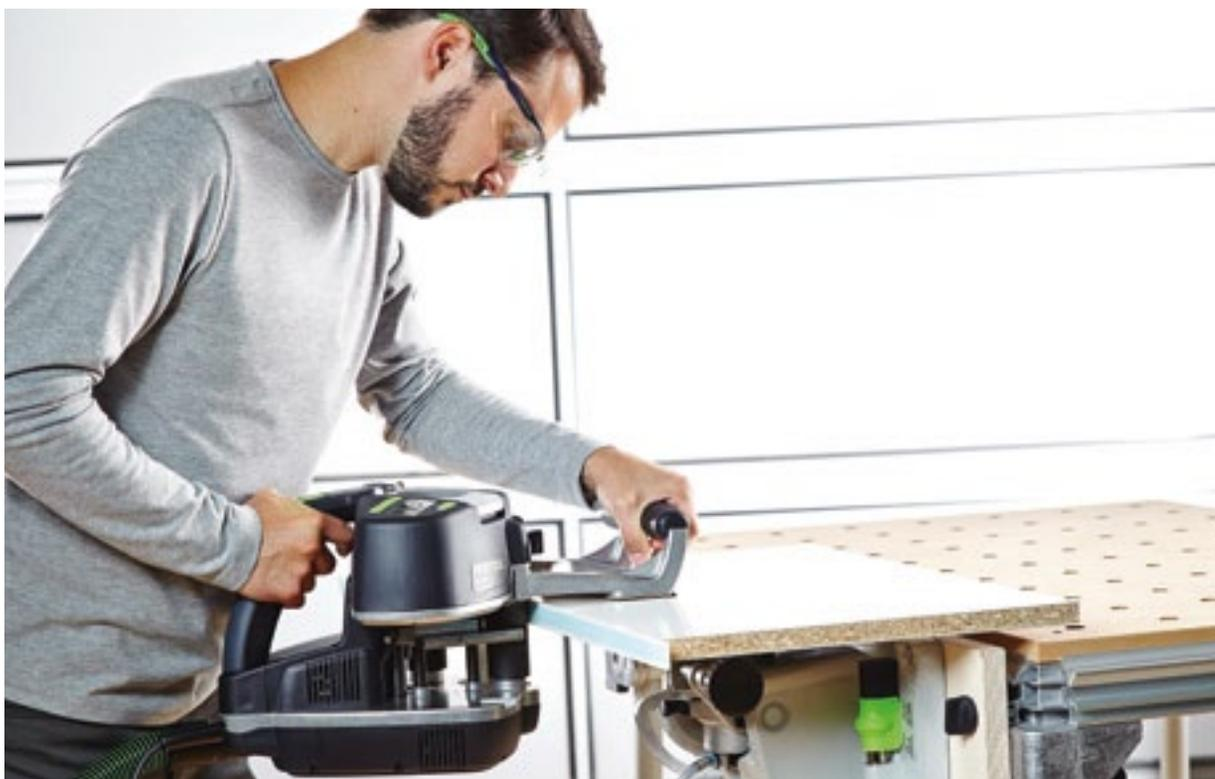
CONTURO ora è pronto per applicare il bordo sul pezzo. È importante che il pezzo sia bloccato in sicurezza. Si può lavorare con morsetti bloccati sul piano multifunzione MFT oppure utilizzando il sistema di bloccaggio a ventosa VAC SYS o la combinazione di entrambi. Nella foto di esempio il pezzo è stato bloccato con VAC SYS, in modo da renderlo accessibile da ogni parte – la situazione ideale anche in caso di pezzi circolari.
