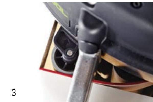
Non appena l'estremità iniziale del bordo raggiunge l'angolo interno, guidare la macchina esercitando una pressione omogenea dallo spigolo interno. Premere contemporaneamente con il pollice della mano destra sull'inizio del bordo nell'angolo interno in modo da ottenere un incollaggio ottimale.
