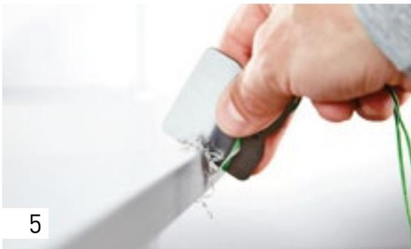
Nel caso in cui dopo la fresatura si sentano i passaggi della lama, lisciarli con il raschietto.
