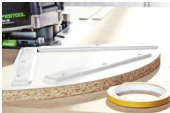
**CONSIGLIO** Se occorre svitare completamente la soletta di scorrimento, fissarla semplicemente con nastro biadesivo sulla parte inferiore del pezzo sagomato – che in questo modo è di nuovo all'altezza giusta rispetto al sistema di incollaggio dei bordi o al nastro per bordi – e si ottiene la giusta sporgenza del bordo.
