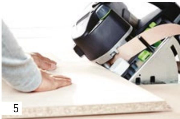
Posizionare il pezzo sul riscontro di guida e avvicinarlo con forza omogenea a CONTURO. Per non far sì che il bordo introdotto finisca nell'area di lavoro, guidarlo attraverso il perno di guida nero.
