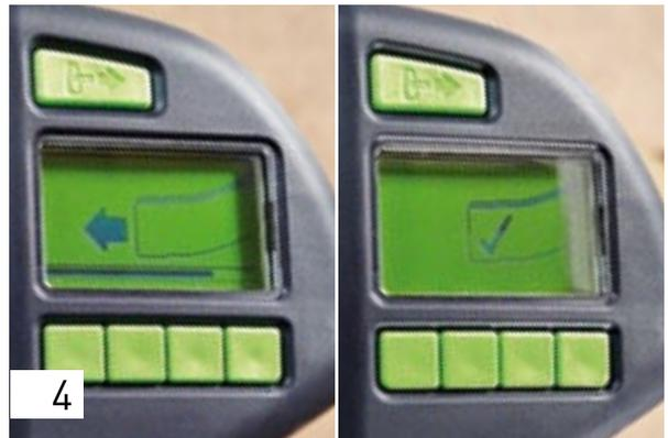
Se compare il simbolo per l'inserimento del bordo, inserire il bordo con l'avanzamento in corso finché non viene agganciato. Non appena compare il segno di spunta sul display, significa che il bordo ha raggiunto la posizione di partenza e la macchina è pronta per l'incollaggio.
