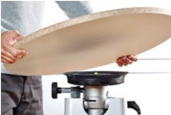
Nella bordatura perimetrale di pannelli è importante che il pezzo sia accessibile da ogni parte senza dover riposizionare l'attrezzatura. A tale scopo è consigliabile usare il sistema di bloccaggio a ventosa VAC SYS, con cui è possibile bloccare in modo rapido e sicuro i pezzi, che diventano girevoli di 360° e inclinabili fino a 90°.
