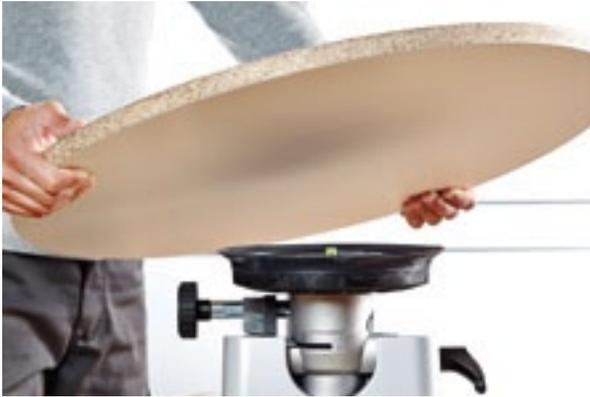
Quando é necessário colocar orlas em vários lados da placa, é importante que a peça de trabalhar esteja acessível por todos os lados, sem alterar a montagem. Para tal, recomenda-se a aplicação do sistema de fixação por vácuo VAC SYS – com o qual as peças a trabalhar podem ser fixas de forma rápida e segura e, depois, é possível rodá-las 360° e basculá-las até 90°.
