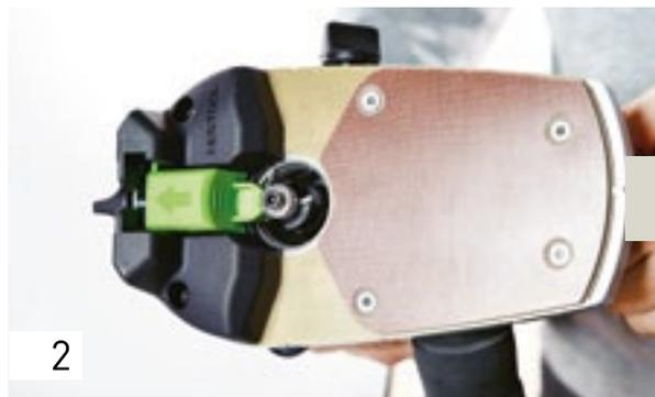
Primeiro, frese a saliência da orla com a MFK 700, de forma rematada à placa. Prático: o tubo flexível de aspiração coloca-se diretamente no tampo da bancada e, assim, não perturba a condução da ferramenta. O travão de rolamentos permite obter resultados perfeitos e sem estrias.
