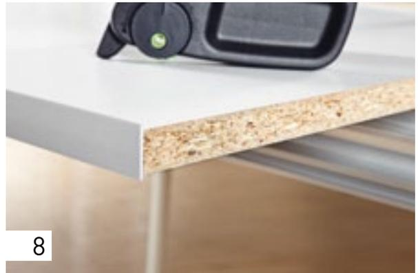
O resultado: uma orla perfeitamente rematada. Aliás: a ferramenta de chanfrar KP 65/2 é adequada para orlas com uma altura de 18–65 mm, bem como uma espessura de 0,5–2,0 mm. Através da disposição dos punhos no sentido da chanfragem, torna-se claramente mais fácil chanfrar mesmo orlas mais grossas.
