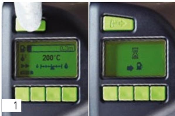
1 Pressione a tecla de reabastecimento e aguarde até que o avanço da cola tenha recuado. O visor indica agora que a ferramenta se encontra no modo de abastecimento. Antes de abrir a tampa, aguarde até que o símbolo de ampulheta se tenha apagado.
