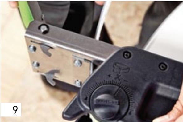
Posicione o aparelho de chanfrar de modo a que a marcação do rebordo se encontre aproximadamente entre as lâminas de chanfrar. Utilize o ajuste de precisão: pode ver na escala se tem de cortar mais ou menos do rebordo. Assim que a marca se encontrar exatamente entre as lâminas, corte a orla.
