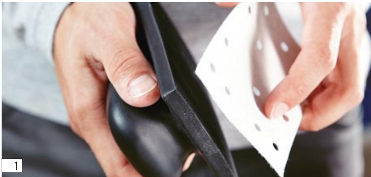
Primeiro, equipe a sapata para lixagem manual com uma lixa adequada (Brilliant 2, granulação P320).
