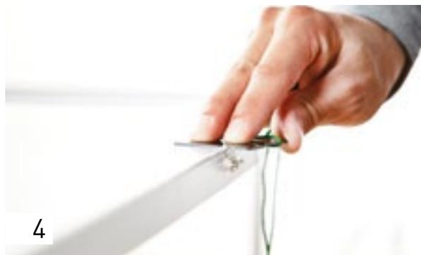
Para obter uma orla limpa e arredondada, aproxime a fresadora em funcionamento à orla e frese a saliência e o raio.
