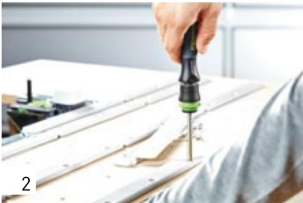
Depois, monte a placa de adaptação e as placas deslizantes de acordo com as instruções de utilização. As placas deslizantes facilitam a orientação da peça a trabalhar na bancada. São fornecidas automaticamente 15 peças com a placa de adaptação; estão disponíveis mais placas deslizantes como acessório.
