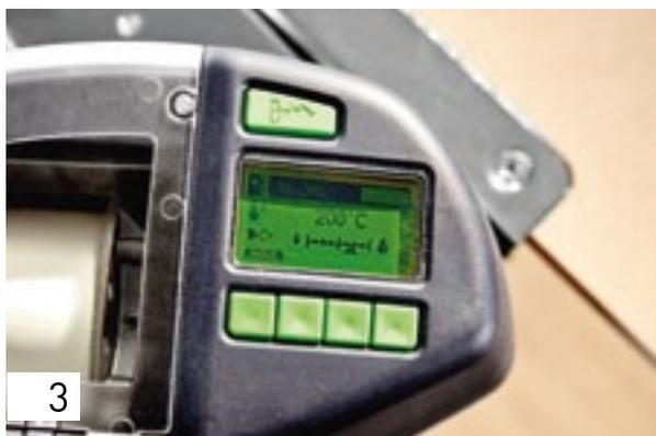
Verifique se está ajustada a velocidade pretendida. Ao contrário do que acontece com o processamento móvel de orlas, agora tem as duas mãos na peça a trabalhar e dificilmente pode alterar a velocidade durante o processo de colagem.
