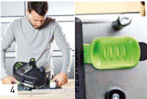
Depois, solte o bloqueio à direita e à esquerda na placa, introduza a CONTURO e bloqueie de novo.
