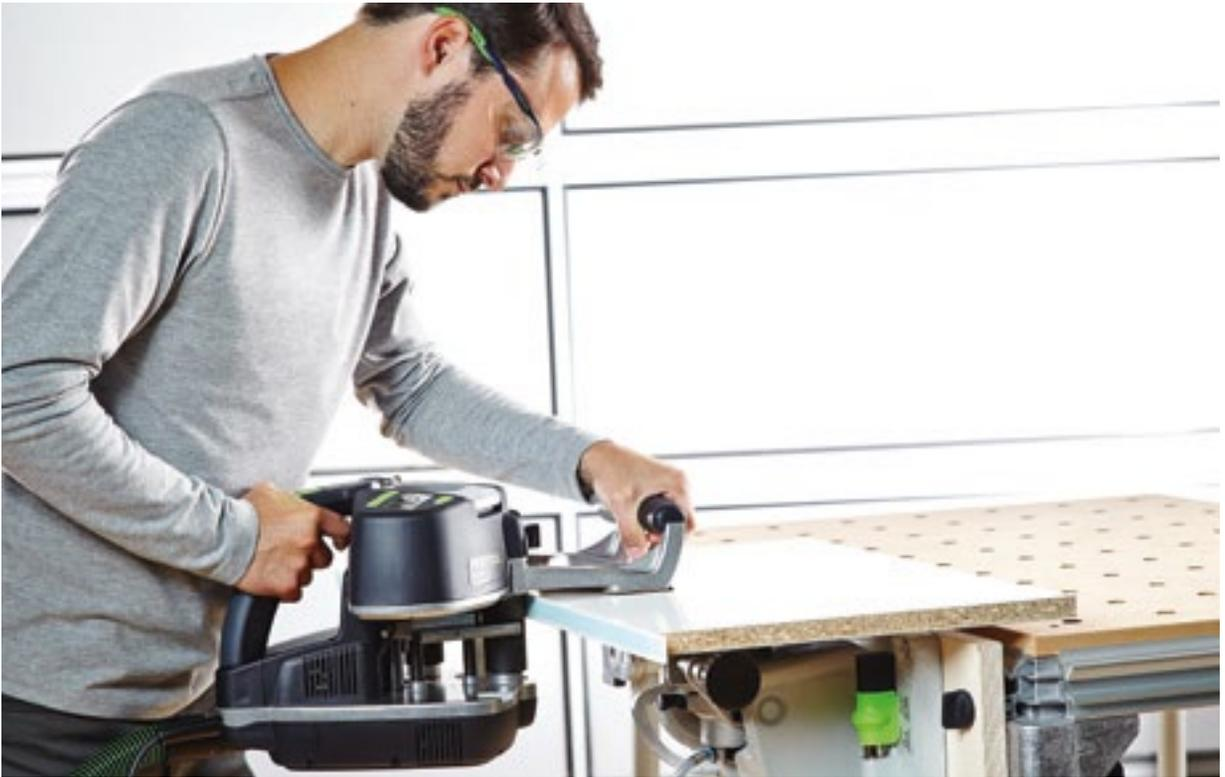
A CONTURO está, agora, pronta para começar a colar a orla na peça a trabalhar. Aqui, é importante que a peça a trabalhar esteja bem fixa. Pode trabalhar com grampos de fixação ou de alavanca sobre a bancada multifuncional ou utilize o sistema de fixação por vácuo VAC SYS ou uma combinação de ambos. No nosso exemplo, a peça foi fixada com VAC SYS, pois, assim, fica livremente acessível por todos os lados – ideal ao processar orlas em peças redondas.
