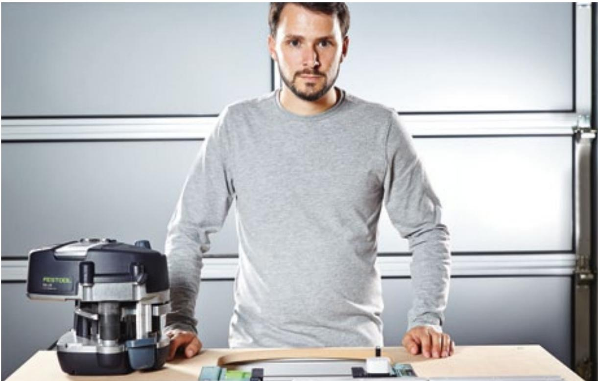
Também pode trabalhar de modo fixo com a CONTURO. Para tal, basta situá-la sobre a placa de adaptação na bancada multifuncional MFT/3 ou numa bancada produzida por si mesmo. Isto permite não só o processamento de orlas retas ou partes arredondadas, mas também de orlas oblíquas com ângulos de 90°–45°, pois a CONTURO na unidade estacionária pode ser basculada entre 90° – 45°.
