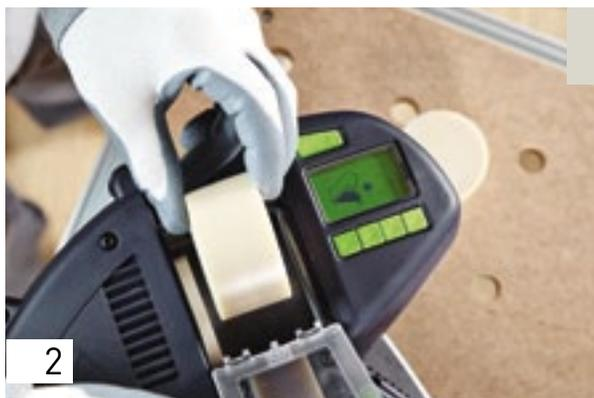
Agora, regule a temperatura de funcionamento para 140 °C (para uma regulação manual da temperatura, consulte a pág. 23). Insira um novo cartucho de cola PU e pressione-o para dentro do sistema até meio aproximadamente, até que deixe de ser visível qualquer mistura. Aguarde, até a CONTURO ter arrefecido até aos 140 °C – agora, a ferramenta está pronta a ser utilizada.
