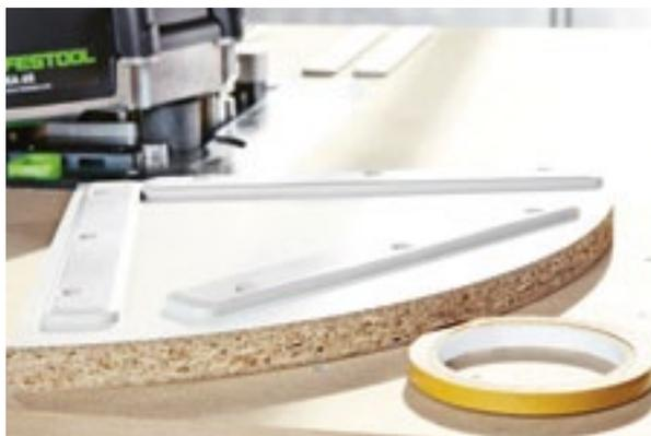
**CONSELHO** Se for necessário desaparafusar todas as placas deslizantes, fixe-as simplesmente com fita adesiva de dupla face na parte de baixo da peça recortada – assim, esta fica novamente com a altura certa em relação à orladora portátil ou ao rebordo e consegue-se a saliência de orla certa.
