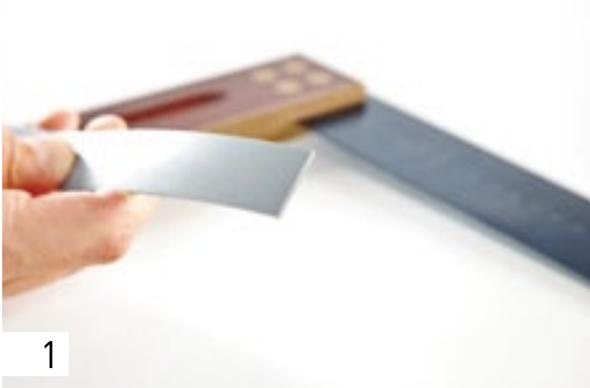
Ao cortar o rebordo à medida, lembre-se de adicionar aprox. 10 cm. Corte a peça inicial em esquadria perfeita, pois este corte chanfrado dá automaticamente origem a uma parte da junta.
