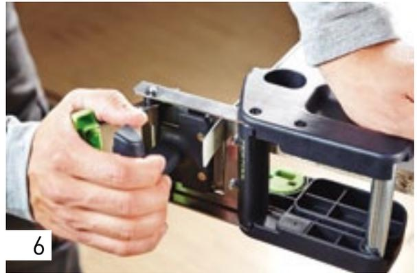
O corte da saliência da orla só é feito com a ferramenta KP 65/2 da Festool: inserir o rebordo entre as lâminas de chanfrar, posicionar o aparelho até ao perno de batente, paralelamente à peça a trabalhar, e apertar os punhos.
