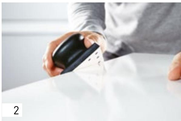
Ao polir as orlas, pode eliminar as marcas da lâmina que surgem durante o processo de fresagem. Para tal, mova suavemente a sapata para lixagem manual sobre a orla, em movimentos uniformes.
