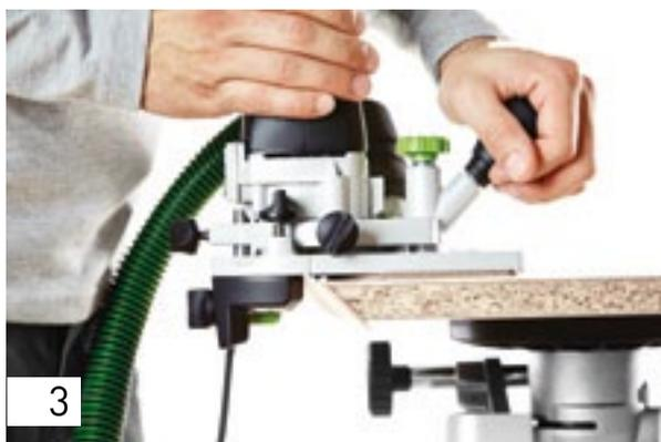
Tenha atenção para que a parte inferior da cobertura de aspiração encoste diretamente à peça a trabalhar e, assim, possa ser utilizada como guia.
