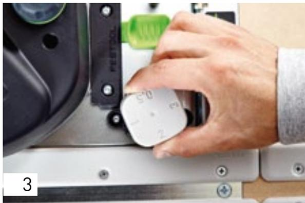
Para que a orla não seja colada de modo descentrado e oblíquo, utilize simplesmente o batente-guia e, assim, assegure uma condução paralela da peça a trabalhar. Ajuste o batente-guia à espessura da orla utilizada; são possíveis espessuras de orla de 0,5, 1; 2 e 3 mm.
