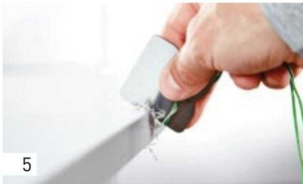
Se ainda se sentem as marcas de lâmina do processo de fresagem, alise-os com o raspador.
