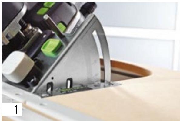
Solte ambos os parafusos de aperto na escala angular, ajuste o ângulo pretendido e aperte de novo os parafusos de aperto.
