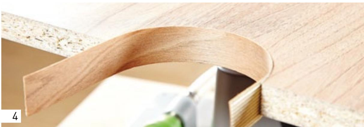
Tal como no processamento de orlas retas, corte a extremidade sobressalente da orla de forma rematada, com a ferramenta de chanfrar.
