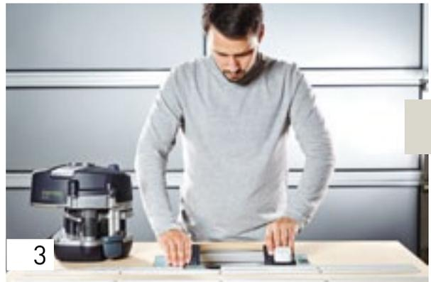
Como montar a CONTURO na placa de adaptação: primeiro, incline a placa de adaptação para cima para a bloquear.
