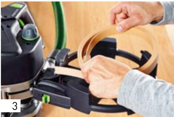
3 Coloque a orla enrolada no reservatório de orlas e posicione a extremidade da orla no sentido da inserção de orlas na ferramenta.
