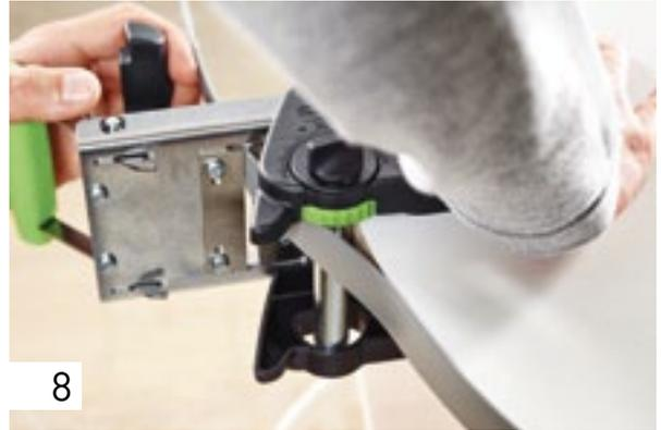
Passes o rebordo sobressalente sobre o perno de batente entre as lâminas de chanfrar. Pressione o aparelho de chanfrar até ao perno de batente dianteiro na peça a trabalhar, até que o rebordo já colado encoste no batente interior.
