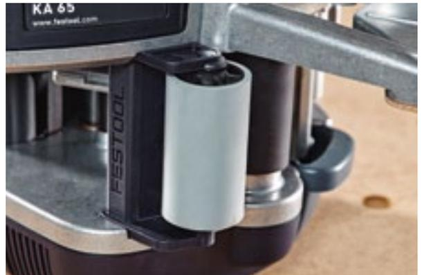
Para raios apertados e locais de difícil acesso, o rolo adicional (acessórios) é uma boa ajuda. Ele aumenta o raio de curvatura da orla e oferece um ponto de pressão adicional ao colar, para um melhor comportamento da colagem. Para a montagem do rolo adicional, empurre-o na ranhura prevista para o efeito, até engatar.
